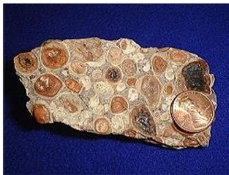
Bô xít tự nhiên, một loại đá trầm tích đất sét, được phát hiện tại một thị trấn của Pháp vào năm 1800, là nguyên liệu thô cơ bản để sản xuất nhôm. Alumin thu được từ nó trở thành chất trung gian để sản xuất nhôm đầy đủ giá trị bằng cách điện phân, ở dạng tấm bạc được sử dụng trong nhiều ngành công nghiệp. Ở Ba Lan, nguồn nguyên liệu thô này quá ít nên khai thác ở quy mô công nghiệp không có lãi, do đó phải sử dụng bauxite nhập khẩu từ các nước khác, chủ yếu là từ Hungary.
